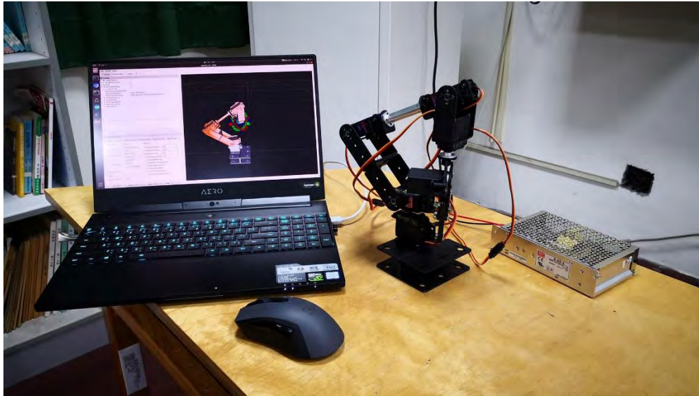
圖 20(電腦將角度傳給單片板以控制手臂)
