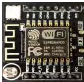
圖六 ESP8266 模組及 RGB LED 顏色設定說明
