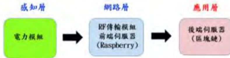
圖 6 具有區塊鏈之 IoT 電能系統的原理圖
