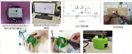
圖13. 自製轉速控制器之製作與組裝過程
