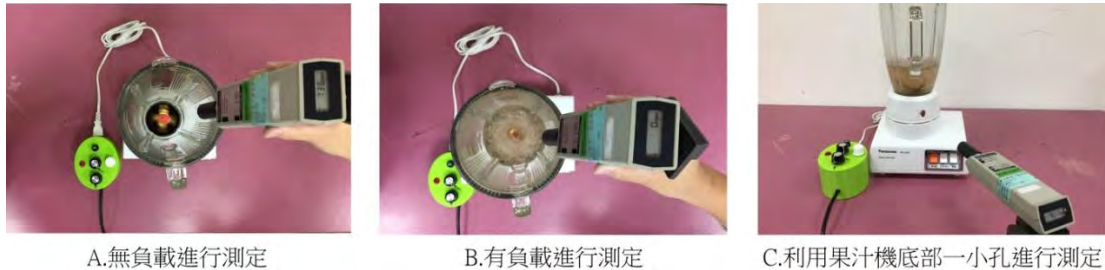
圖 15. 利用轉速計測定果汁機之轉速
