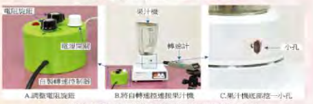
圖14. 利用自製轉速控制器控制果汁機轉速之測試
