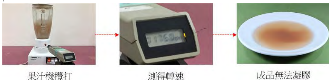
圖 32. 果汁機全速(不加轉速控制器→未減速)攪打愛玉子之測試
