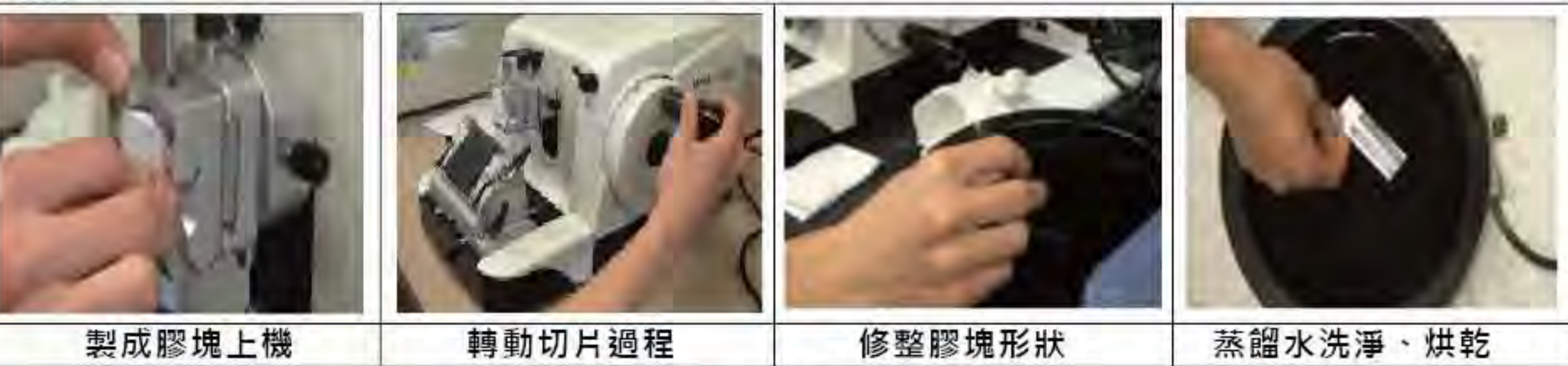
▲圖17 埋膠切片過程
