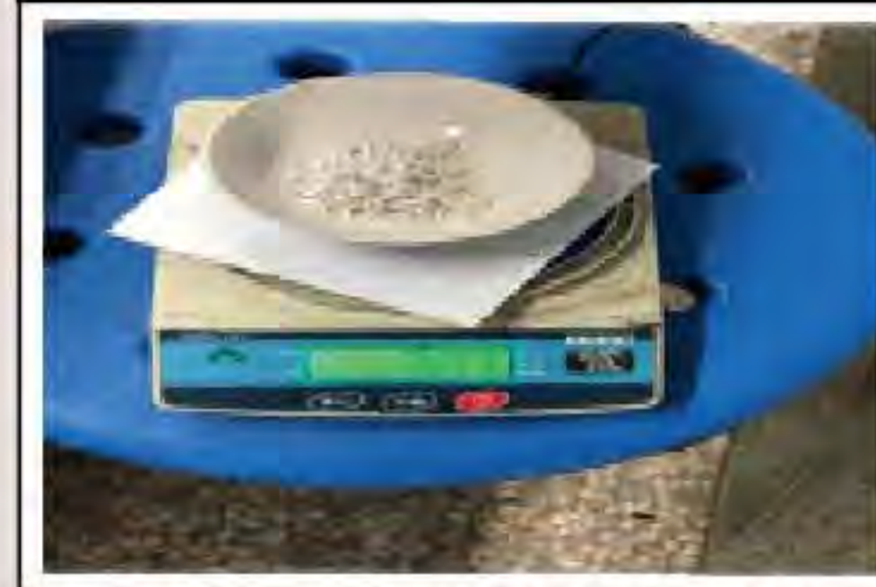
▲圖22. 玄武岩碳酸化實驗過程
