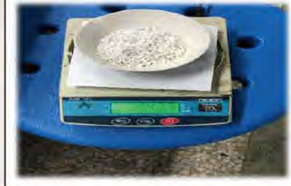
▲圖30. 鹽鹼土碳酸化實驗過程
