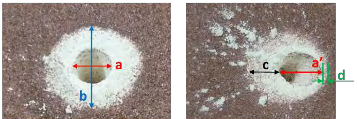
圖 8 a：坑洞直徑長； a'：坑洞的最長距離 b：經坑洞圓心與 a 相互垂直外圓距離 c：前震波影響的距離 d：後震波影響的距離
