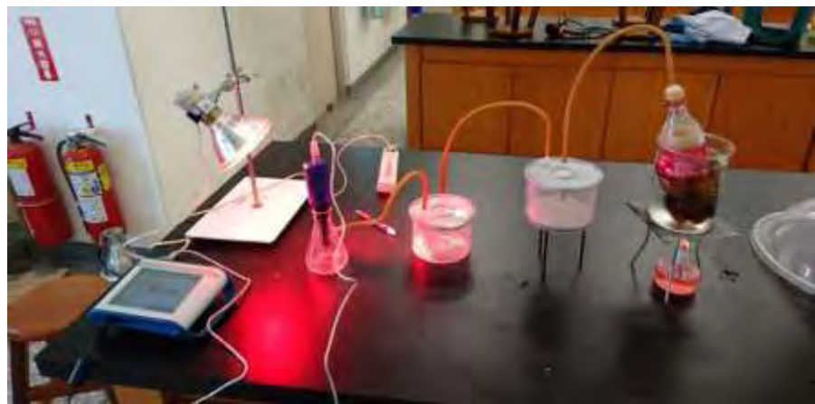
圖 14、冷凍汽水融化釋放出氣體與溫度之變化關係實驗裝置完成圖。
