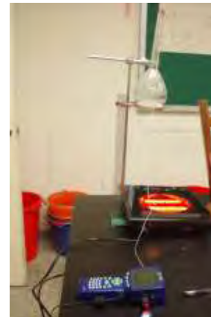
圖 3、紅外線黑晶爐加熱氣體實驗設計圖。 圖 4、紅外線黑晶爐實驗裝置完成圖示。
