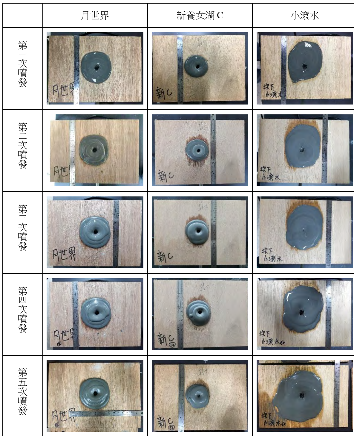
▲表十四、月世界、新養女湖 C、小滾水直徑 12 mm 噴口模型實驗結果
