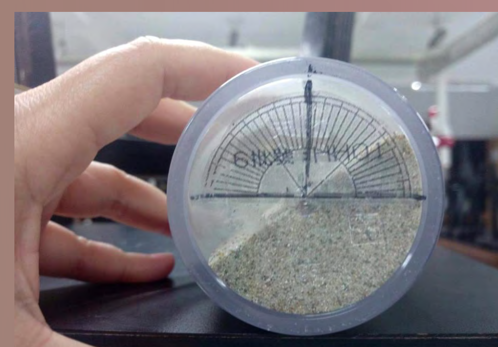
圖九、土壤的休止角 A砂:45度、B砂:40度、 C砂:40度、D砂:48度、 E砂:45度、F砂:43度。
