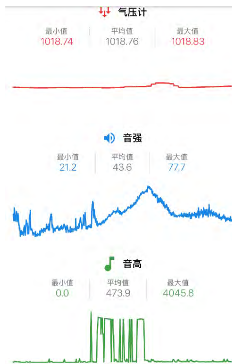
圖 22、google 科學日誌量測噴射客機降落時氣壓、音強及音高(時間軸相同)
