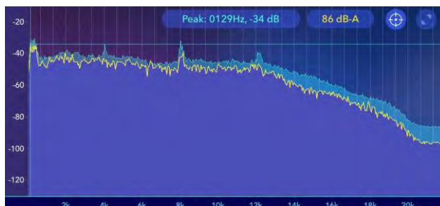
圖 13、以 Spectrum 在停機坪旁量測 ATR72 飛機螺旋槳啟動時之頻譜 (橫座標-頻率，縱座標-強度)
