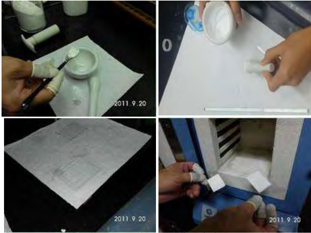
圖一：TiO 2 光觸媒降解平板製作
