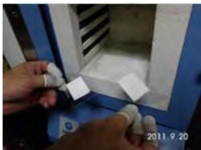
圖一： \text{TiO}_2 光觸媒平板退火
