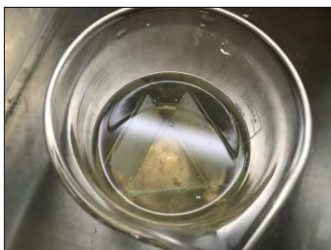
圖二：紫外光激化降解產生奈米銀粒子
