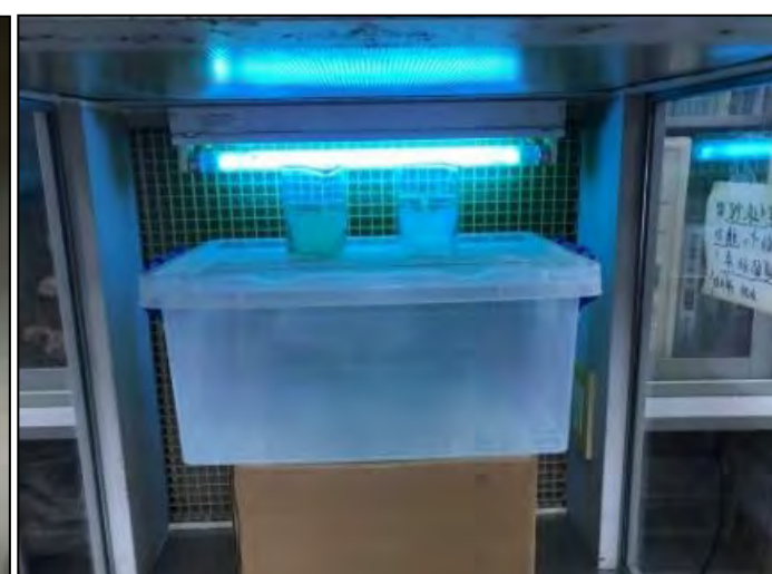
圖二：紫外光激化降解產生奈米銀粒子
