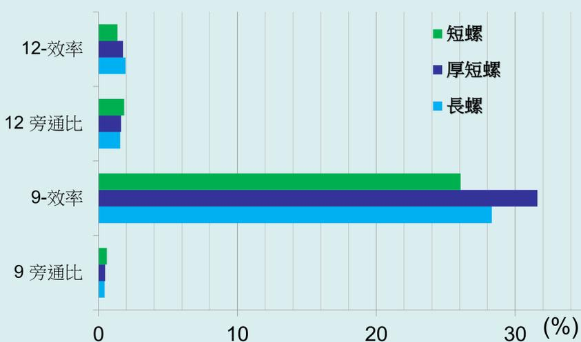
圖4-6.不同旁通比下渦輪機發電效率高低的比較
