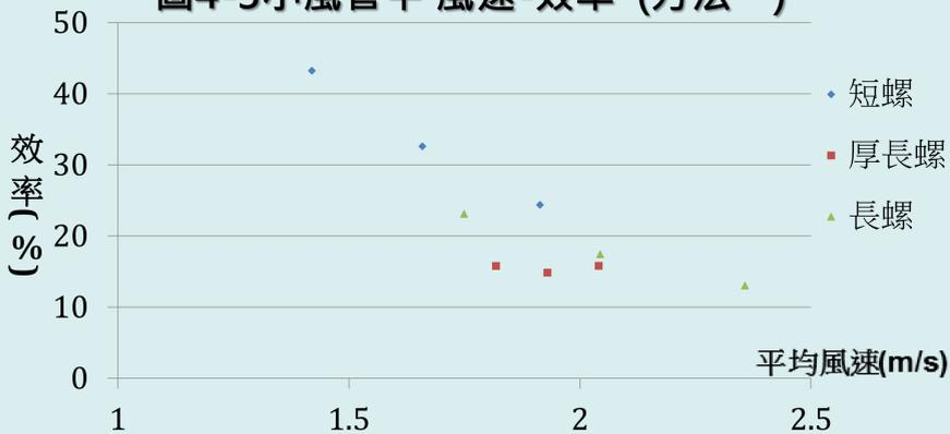
圖4-4小風管中 風速-效率 (方法二)
