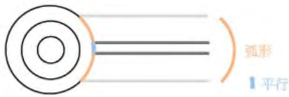
▲圖(二十七): 口徑(狹縫)大小對管口波形影響示意圖
