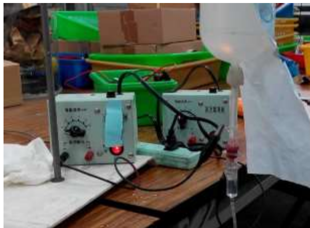
圖 銅線接上電源供應器，讓上下管帶異/同性電
