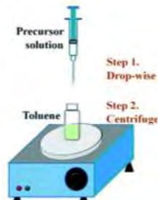
圖六、室溫合成法實驗示意圖
