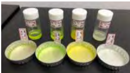
圖十一、細胞粉碎(左)萃取液(右)量子點膜圖示(溶劑：Toluene+PMMA)
