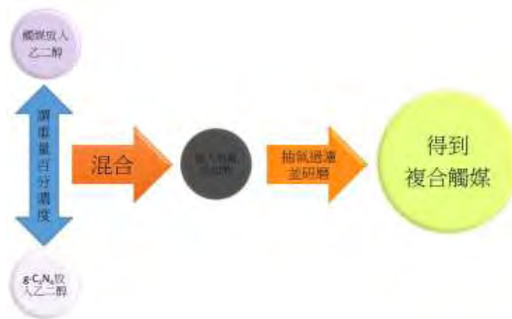
圖九 複合觸媒製作流程圖
