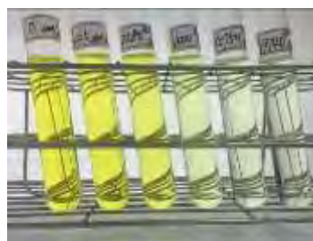
照射不同 UV 強度 Vitamin B 2 溶液
