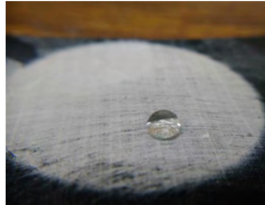
圖 58.蒸鍍後的瞬間膠用砂紙磨擦後具有疏水性
