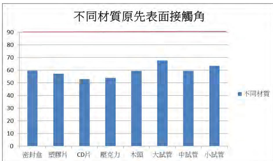
圖 55.沒有進行蒸鍍的各種材質原先表面接觸角
