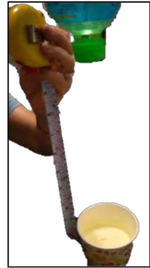
圖 18 測量冰品硬度方法示意圖(初版)
