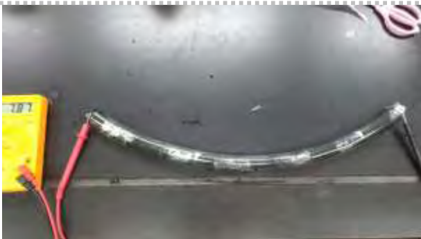
除臭管串聯測得的電壓
