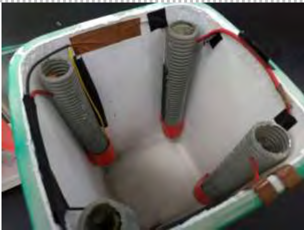
除臭管安裝於廚餘桶內部
