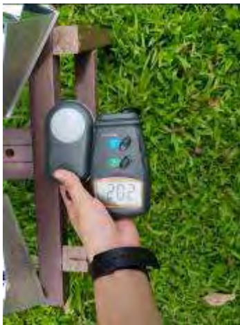
圖 19-1 陽光直接照射(不使用陽光收集器)： 2020 Lux 〈對照組〉
