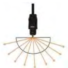
圖31 點光源加裝壓克力半球珠後的光線示意圖
