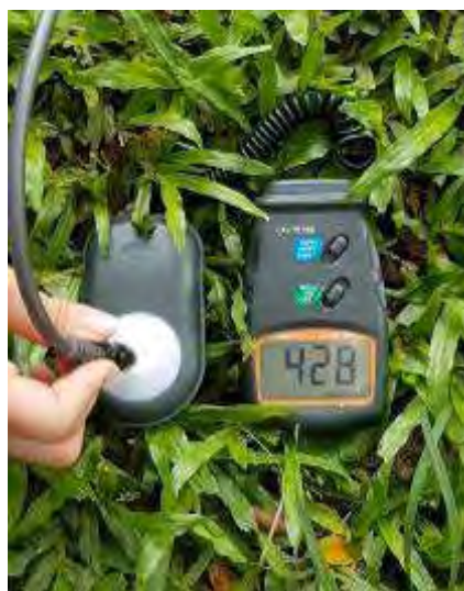
圖 20-2 使用 第三代陽光收集器 收集將光引導至樹蔭下的光度為 42800 Lux。
