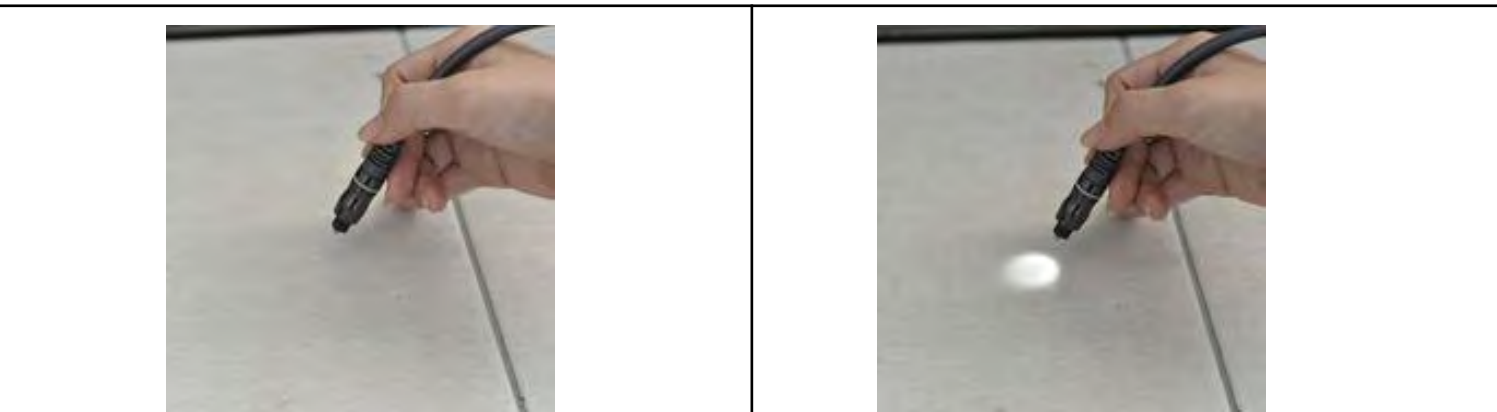
圖26 陽光直接照射光纖； 只有微量光線滲出
