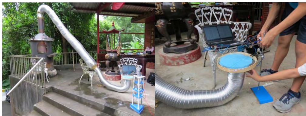
圖 20 實測開爾文裝置之靜電過濾效果
