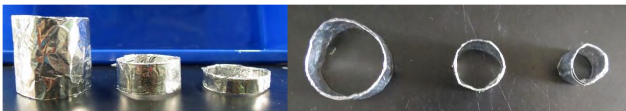
圖 4 不同長度與直徑的鋁箔環
