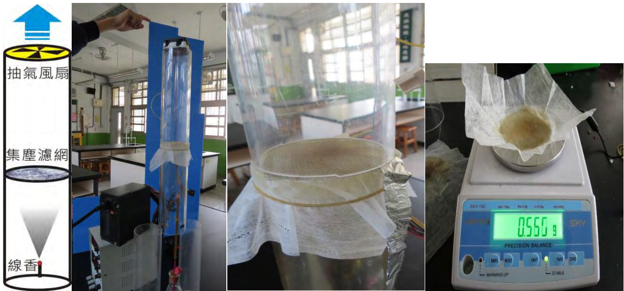
圖 16 線香微粒的集塵裝置(圖左)，金屬網導電於濾網(圖中)，測量濾網增重量(圖右)
