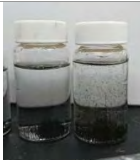
圖 28 利用磁鐵吸附情形 (左圖為複合銀前，右圖為複合銀後)
