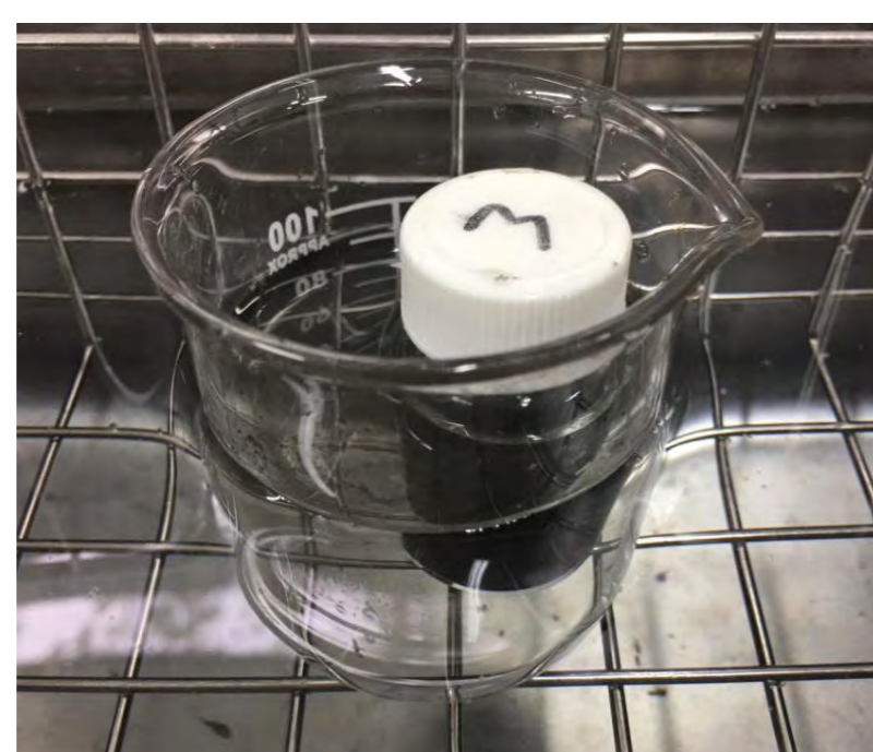
圖29 在超音波震盪機下進行表面改質
