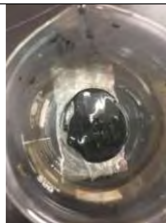
圖 16 利用強力磁鐵吸附、清洗後產物
