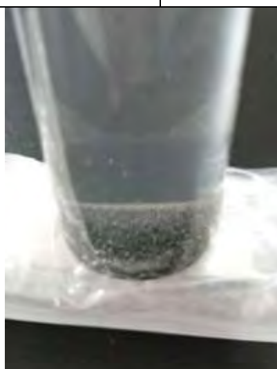
圖33 反應後的試劑以強力磁鐵進行吸附情形
