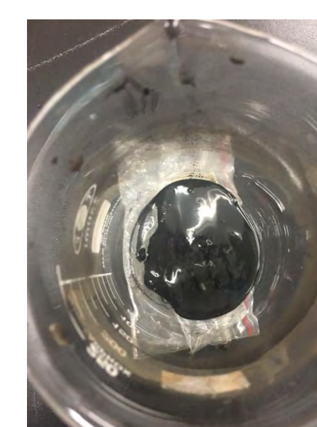
圖13 利用強力磁鐵吸附、清洗後產物
