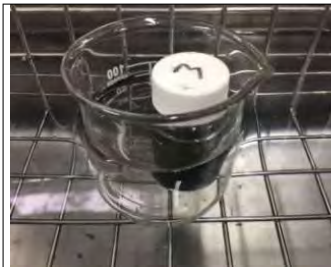
圖30 在超音波震盪機下進行表面改質
