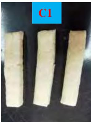
圖 9:玉米澱粉製成的生物塑膠
