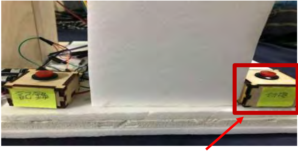
圖(二十五) 第四版--多手指開鎖的裝置 新增了切換手指
