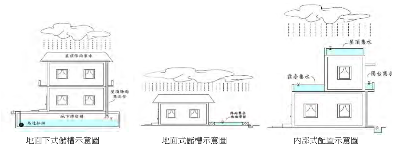
圖 2-1-1 建築物滯洪設備形式 (摘自新北市政府水利局, 2012)
