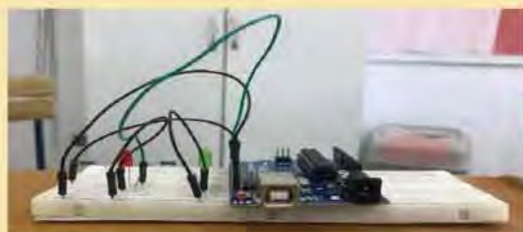
之後加入用Arduino控制板製作的警示器，由紅、藍LED燈泡所組成，當系統偵測到危險時便開啟警示系統。
