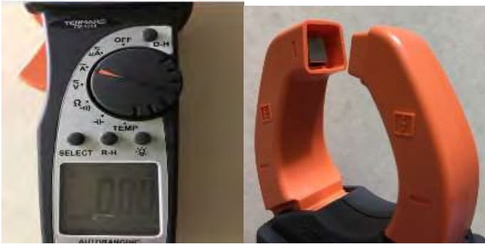
圖 5 電表的微電流檔位，勾表內裝置有矽鋼片
