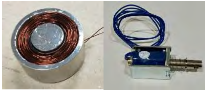
圖 26 自製強力磁鐵與市售電磁閥開關栓鎖結構圖
