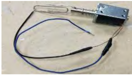
圖 28 以代號 25 線徑 0.4mm 的線圈繞製電磁閥的結構圖
