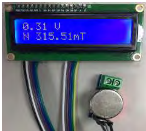
圖 23 自製霍爾高斯計及其 Arduino 模組量測之第 6 種磁鐵(圓柱體)
