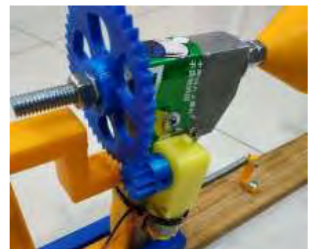
圖三十五、以馬達帶動齒輪使兩傘旋轉
