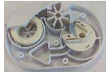
圖二十一、束口機結構
