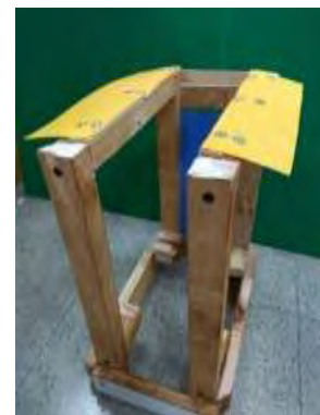
圖二十、傾斜支撐板
