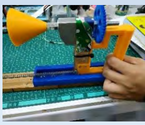
圖 22 適用不同傘長的伸縮夾器
