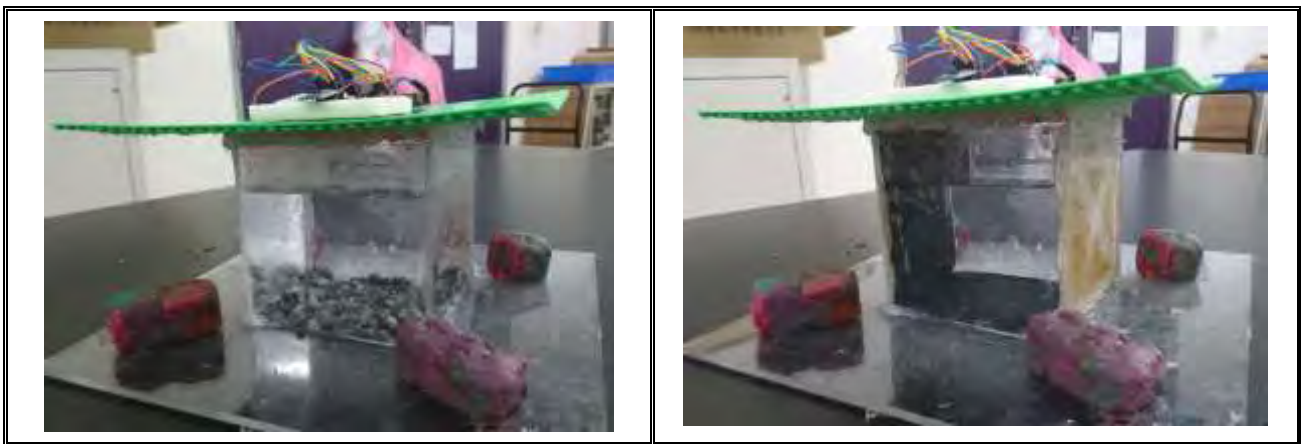
圖 17 不同粗糙度水塔設計裝置圖(註 左:底部放小石頭;右:砂紙安置於底面和側面上)
