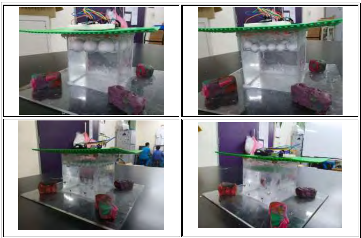
圖 19 不同保麗龍球水塔裝置圖(註 左上:2r=3.25cm;右上:2r=1.91cm
