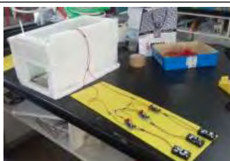
圖 40：串聯三個電蚊拍的裝置
