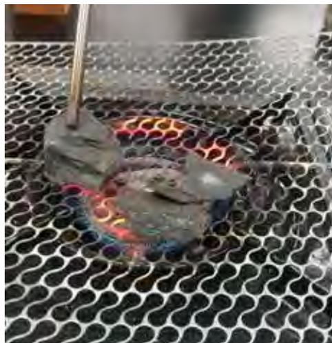
照片 10：加熱過程中板岩炸裂
