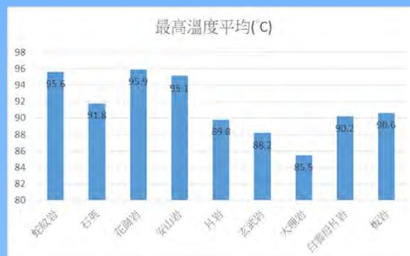
圖4:石材加熱之水最高溫度比較
