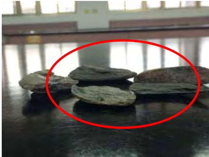
照片 15：片岩加熱後碎裂情形
