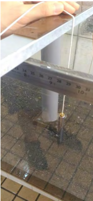
測量沖刷坑深度
