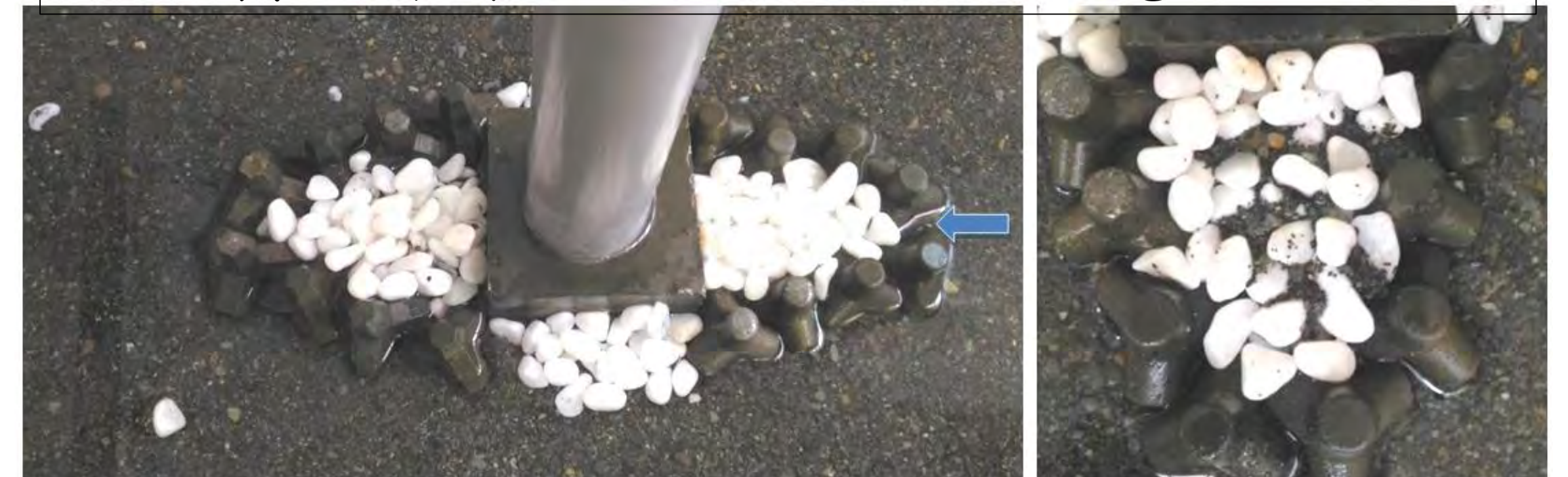
200年洪水-正三角形排列+上游變體1+下游協克塊+大拋石之沖刷坑剖面圖。
