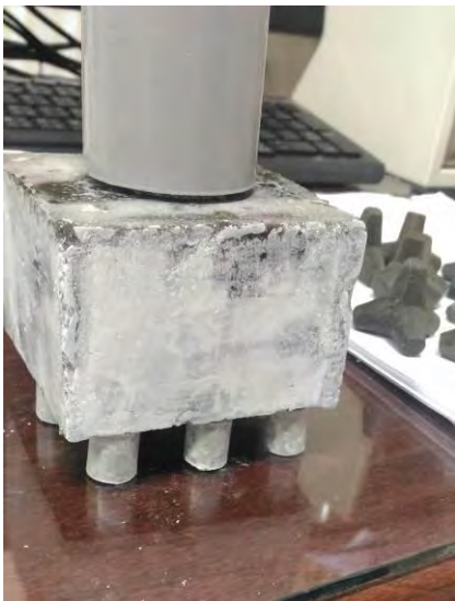
水泥橋墩+沉箱基礎 埋入砂中佈置圖
