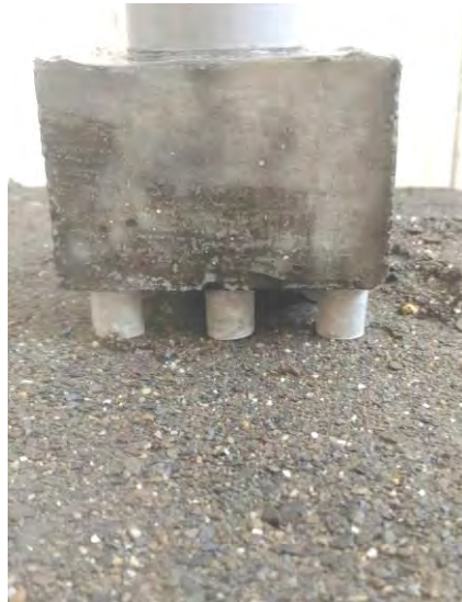
水泥橋墩+沉箱基礎 埋入砂中佈置圖
