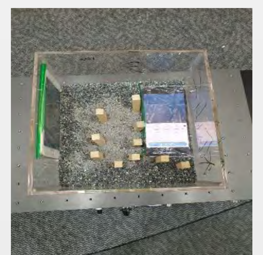
圖四 將地層模型置入地樁之俯視圖。
