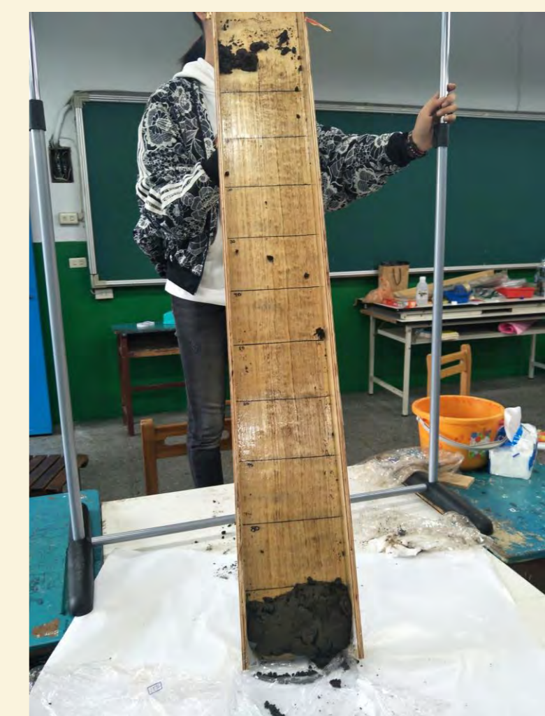
土壤含水量30% 整塊崩塌滑落
