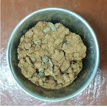
圖 25 經水流侵蝕後之剩餘土壤含水量 25% 土石烘乾後樣貌
