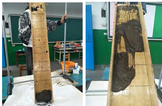
土壤含水量 30% · 整塊崩塌滑落 土壤含水量 30% · 整塊崩塌滑落 圖 29 發生部坡度實驗土壤(校內花園)
