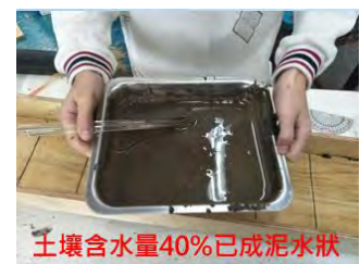
土壤含水量 40% 已成泥水狀 圖 30 發生部坡度實驗-土壤含水量 40% (校內花園)
