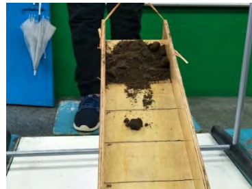
圖 32 發生部坡度實驗-虎頭山土樣
