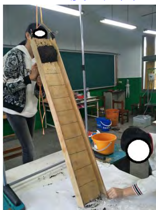
圖 28 發生部坡度實驗-土壤含水量 25% (校內花園)
