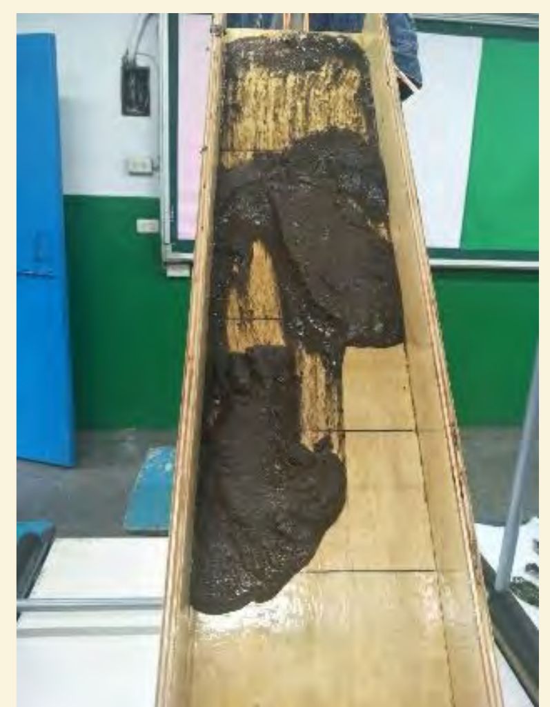
土壤含水量35% 大塊分塊滑落
