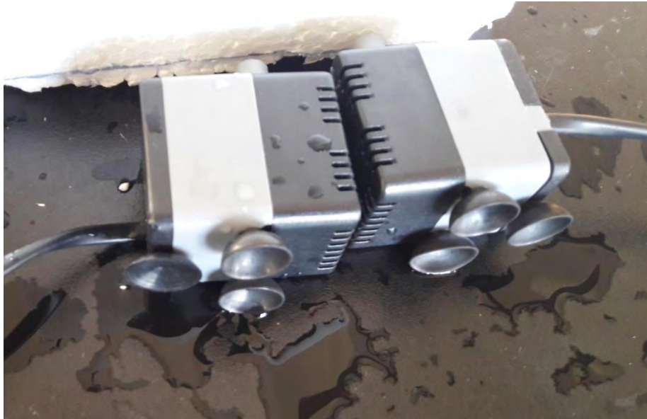
圖七、沉水馬達可帶動水流循環
