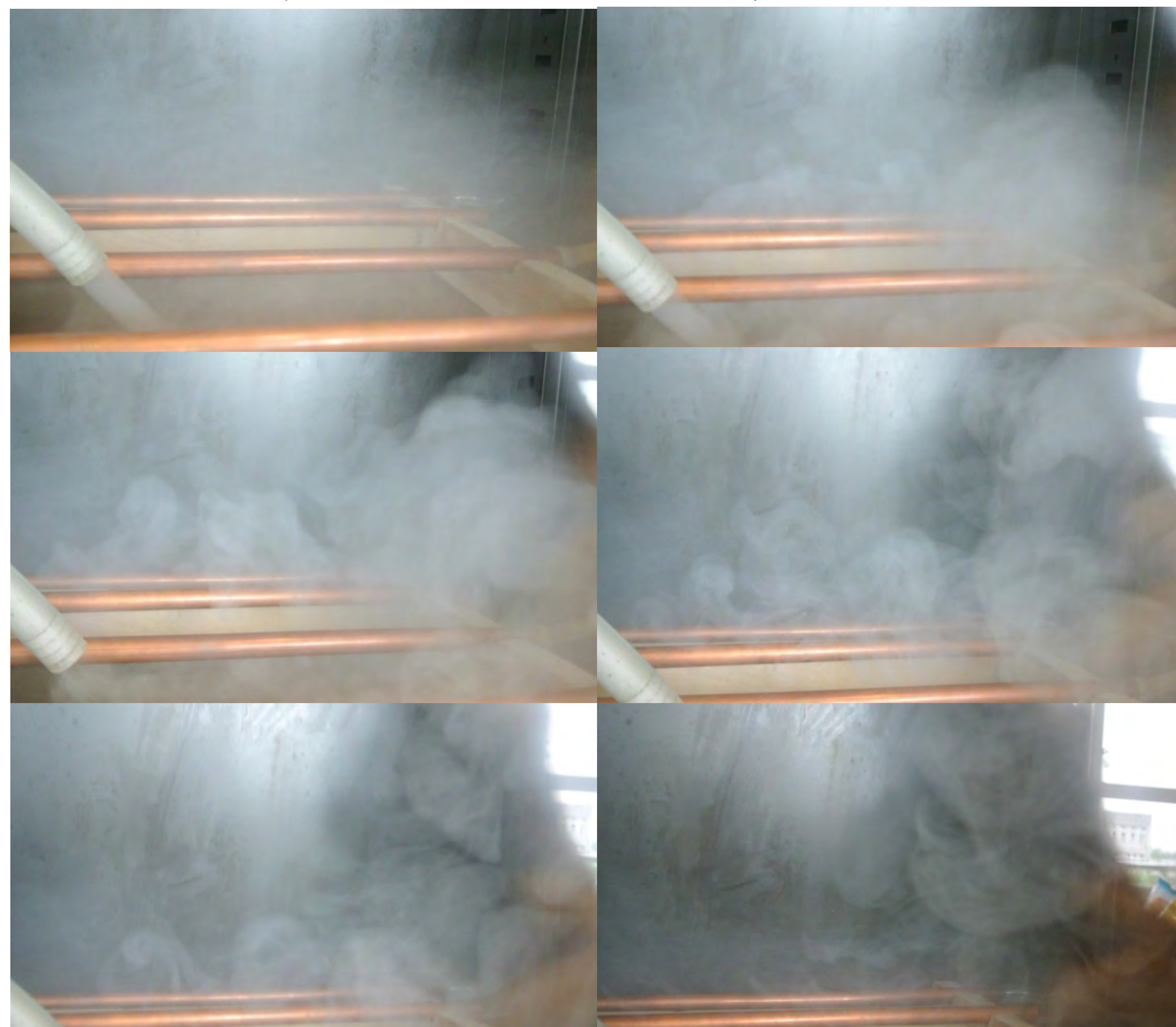
圖二十三、逆溫時的煙霧移動情形，煙霧停滯在底部
