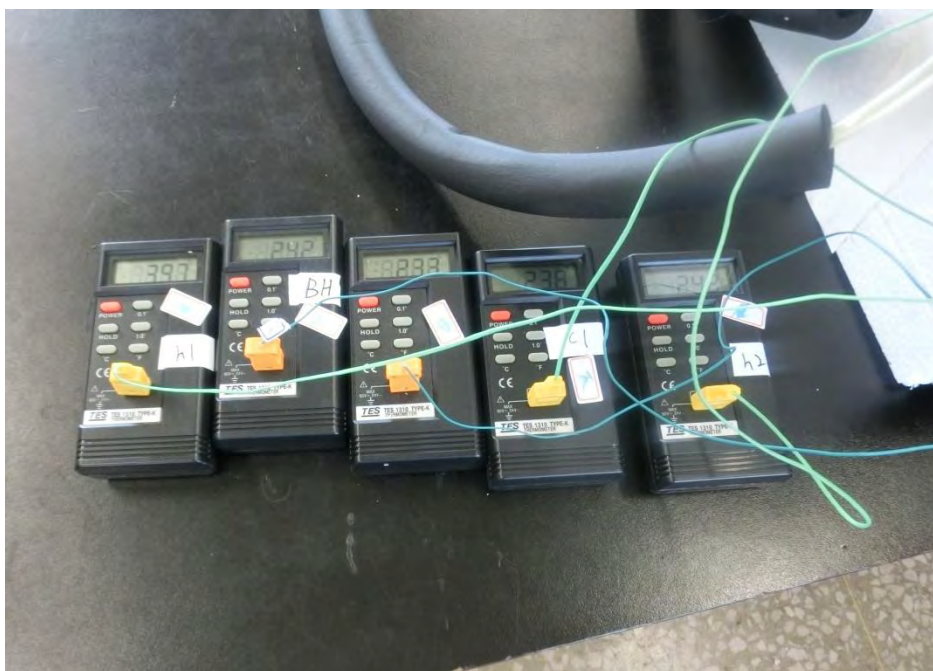
圖五、熱對偶溫度計，在箱內箱外的感應器上貼上標籤，區分五個分層的位置(底、下、中、上、頂)
