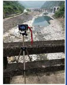
圖4 架設於曾文五號橋上的數位相機
