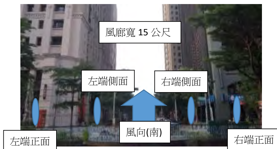
圖三十三、風經過風廊時的測量示意圖
