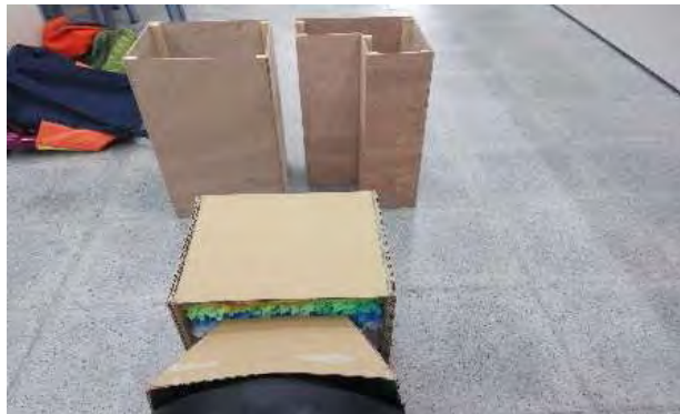
圖二十七、任兩種待測建築物平行放置於距離風洞機 30 公分處
