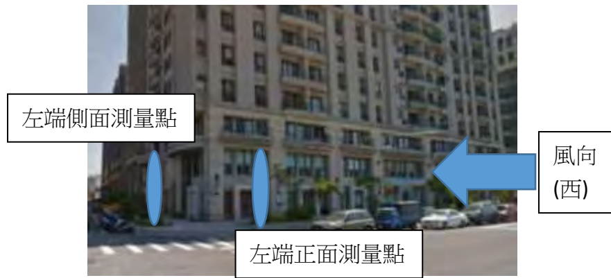
圖三十二、風經過正方形建築物轉角時的測量示意圖(取自 google 地圖街景)
