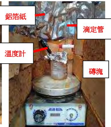
圖 4. 以磚塊及鋁箔紙包圍煮魚鱗裝置，用滴定管每分鐘注入約 0.5 ml 熱水
