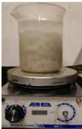
圖 2. 以 10% NaCl，攪拌子攪拌魚鱗 24 小時
