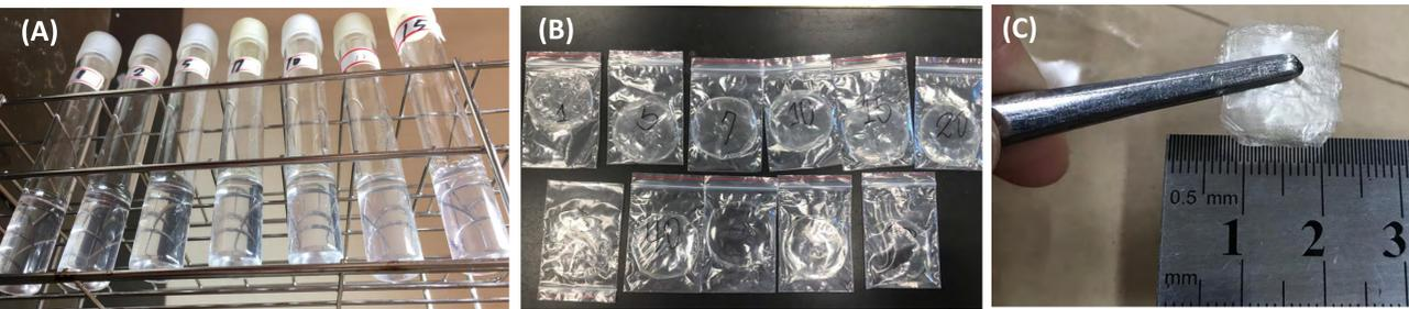
圖5. (A)自製膠原蛋白凍，樣品由左到右乳白色程度增加，顯示濃度越濃；(B)膠原蛋白片；(C)用量測X光繞射之膠原蛋白片。
