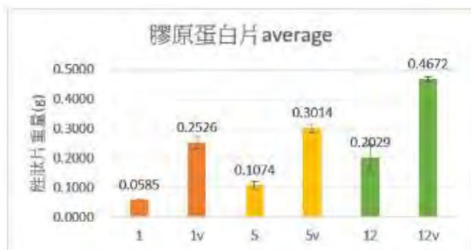
圖 23.用醋水溶液煮不同時間魚鱗膠原蛋白與純水萃取重量比較
