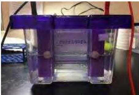
圖 11. 開始跑膠，先以 50V 跑 40 min，之後以 125V 跑 5 min
