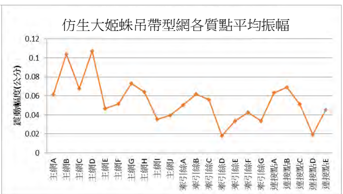
28、仿生大姬蛛吊帶型網各質點平均振動幅度
