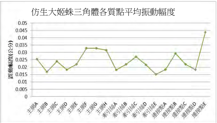
圖 37、仿生大姬蛛三角體蛛網各質點平均振動幅度
