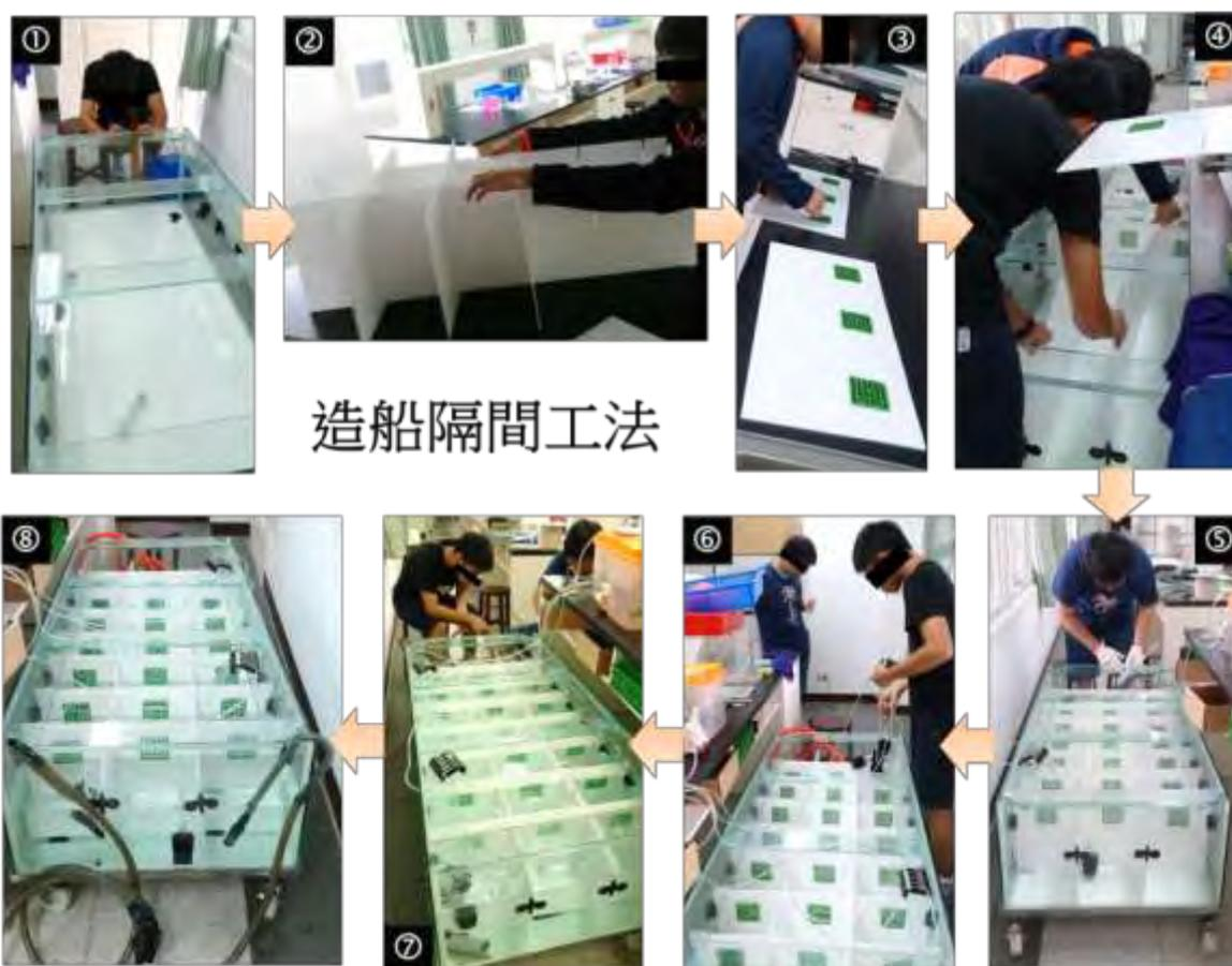
圖三、造船隔間工法施作實況。
