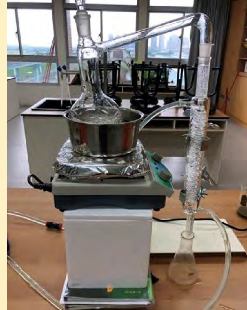
使用油浴的簡單蒸餾法
