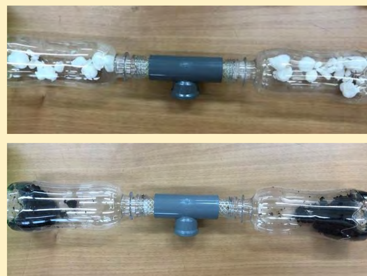
將兩個寶特瓶以T型水管連接分別加入待測物
