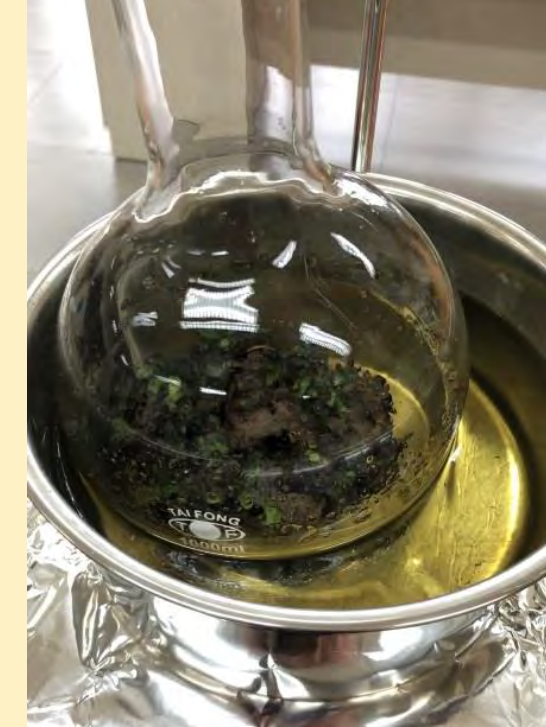
使用油浴的簡單蒸餾法
