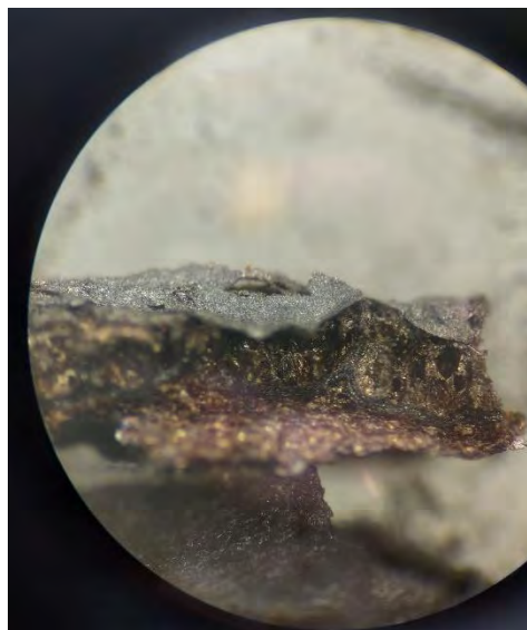
圖 7.花生殼生物炭以解剖顯微鏡(56X)觀察之斷面。
