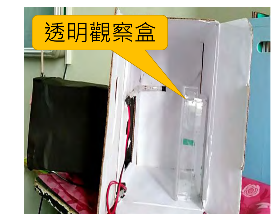
第二代暗箱 箱內亮度的控制變因改同是1500 lux的白、藍、弱綠、紅光的LED燈，而強綠光則為4500 lux。
