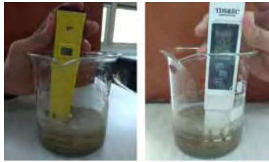
圖 4-7 手持式 pH 及 EC 測試筆測量上層清液
