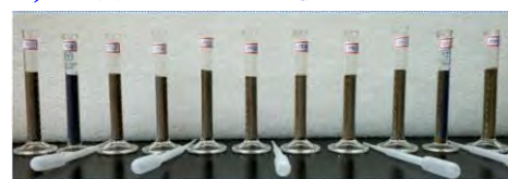
圖 3-21 低濃度 PVA 溶液滴入 Area 2 土樣入滲狀況
