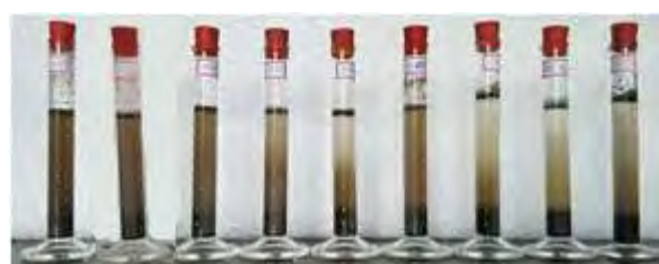
圖 5-10 PVA 溶液與 Area6 土樣混合後靜置 10 分
