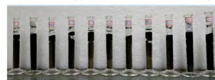
圖 3-22 低濃度 PVA 溶液滴入 Area 6 土樣入滲狀況
