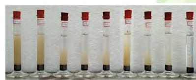
圖 3-14 PVA 溶液與 Area 2 土樣混合後靜置一日
