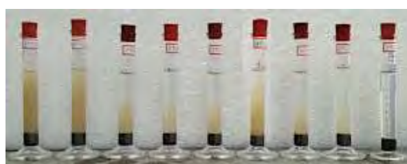
圖 5-9 PVA 溶液與 Area2 土樣混合後靜置一日
