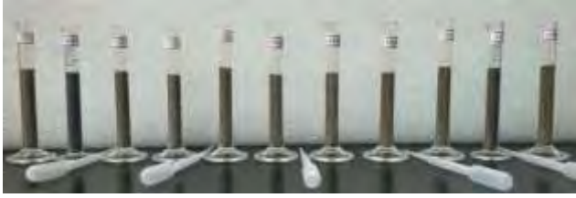
圖 5-15 低濃度 PVA 溶液滴入 Area2 土樣入滲狀況
