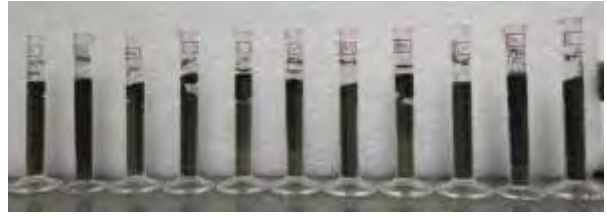
圖 5-16 低濃度 PVA 溶液滴入 Area6 土樣入滲狀況
