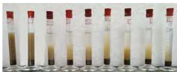
圖 5-8 PVA 溶液與 Area2 土樣混合後靜置 10 分
