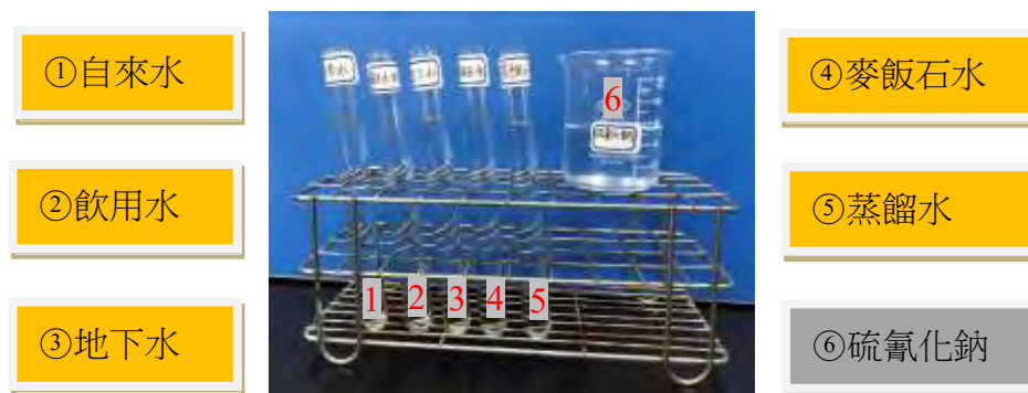
圖(十一) 使用硫氰化鈉檢測不同水質中是否含有鐵離子
