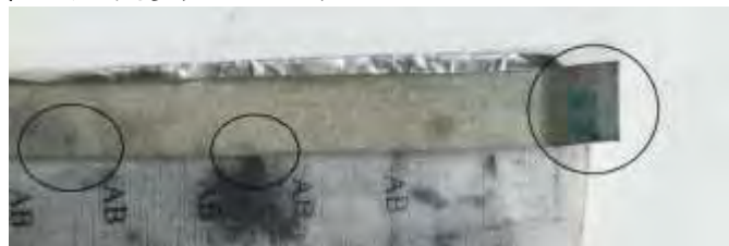
5-3-2-3 導電布生鏽情況(圈起來為銅綠發生處)
