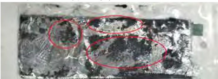
圖 5-5-1-2 G3 靜置後的無塗油酯的鋁片變化(圈起來部分為鋁片破裂處，代表鋁被反應)
