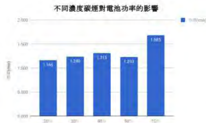
圖 5-1-3-2 電解質中不同濃度碳煙對電池功率的影響
