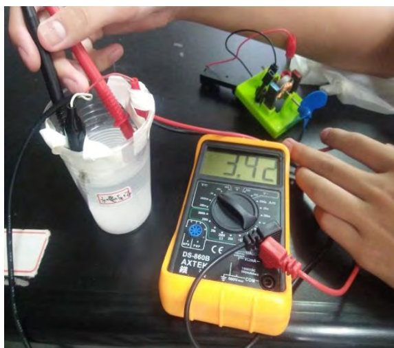
圖三、測量兩金屬相接的電壓
