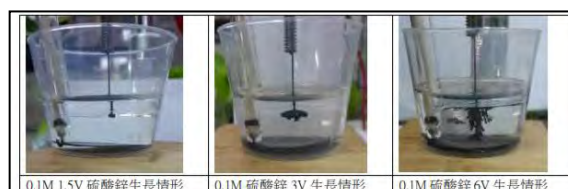
圖 3 截圖自第 58 屆科展作品-鋅花怒放，鋅樹在乙酸乙酯與電解液的界面生長， 需費時調整筆芯到界面位置 ，且使用有機溶劑對人體有 健康的疑慮 。
